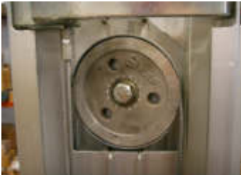
Laufrollen und Kabelschutz aus Stahl
