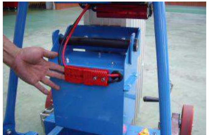
Auswechselbare Gelbatterie geschütz mit Stahl Gehäuse und Schnelle elektrische Verbindung
