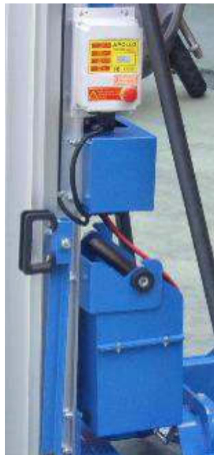
Auswechselbare Gelbatterie geschütz mit Stahl Gehäuse und Schnelle elektrische Verbindung
