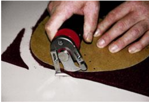
Oberfilzmaterial zuschneiden mit Spezialschneidfuß
