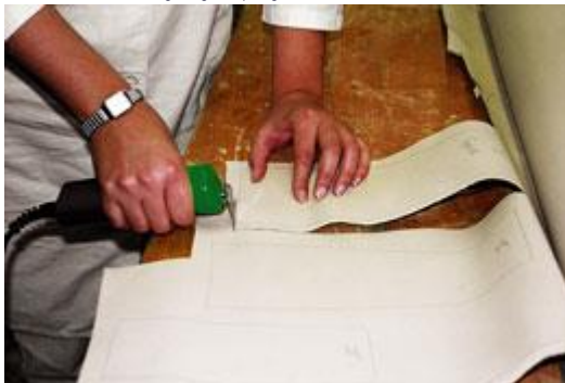
Walkleder zuschneiden unübertroffen: 44 000 Schneidbewegungen pro Minute
