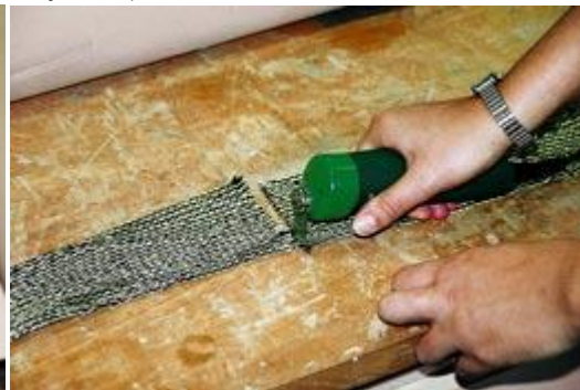
Zuschneiden von 4-Lagen-Stoffteilen für Überbrückungsmieder Das Geheimnis für das Schneiden in neuer Dimension
