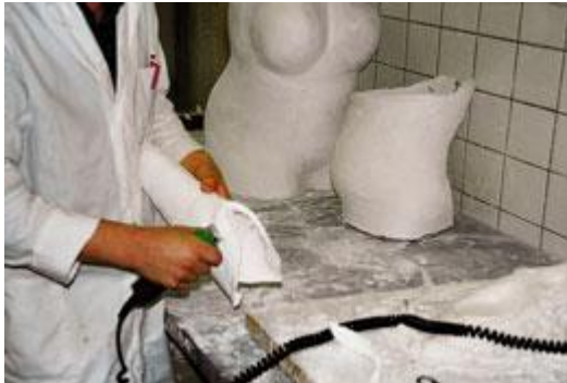
Zuschnittarbeiten und Formgebung an Gipsnegativen
