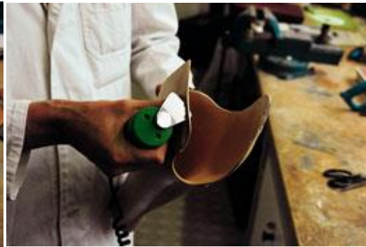
Formgebung am kevlareinverleibten Gießharzschale
